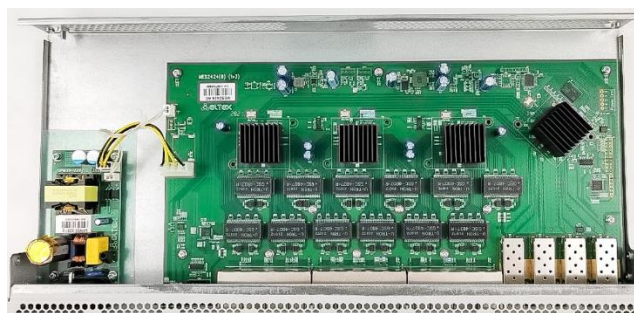
2-rasm. ELTEX MES2424 kommutatori - bu aksiyadorlik kommutatorlariga mansub L2/L3 kommutatoridir.
