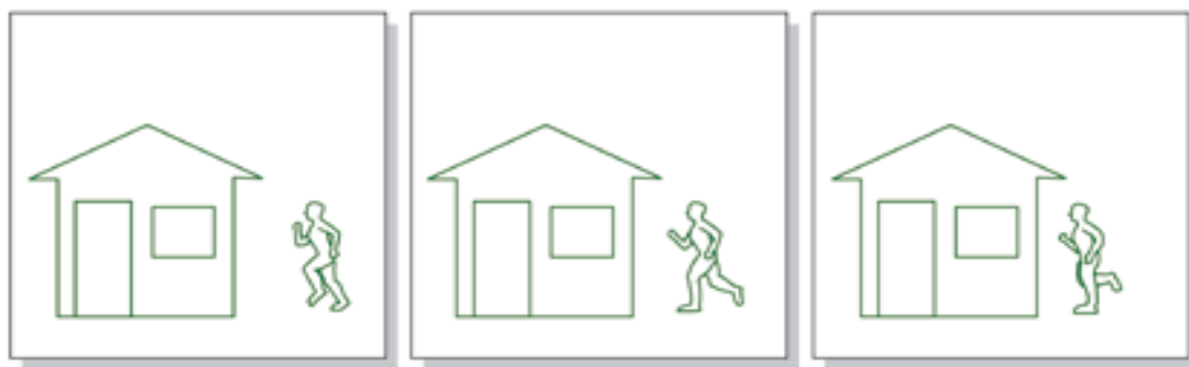
1-rasm. Motion JPEG-da yuqorida ko'rsatilgan ketma-ketlikdagi uchta rasm kodlangan va bir-biriga bog'liqliksiz alohida tasvirlar (I-ramkalar) sifatida yuboriladi.
