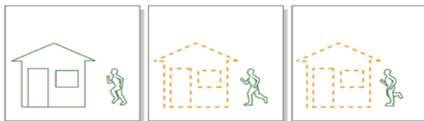
2-rasm. Farqlarni kodlash (ko'pgina videolarni siqish standartlarida, jumladan H.264 da) faqat birinchi rasm (I-ramka) to'liq kodlanadi.
